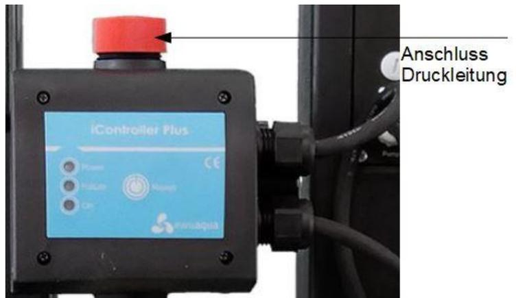
Bild 8.5.1 Anschluss Druckleitung
